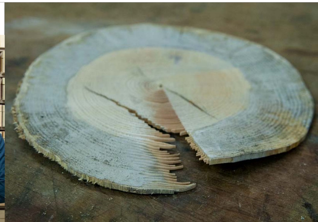
Prototype is gaan golven en barsten tijdens het drogen
